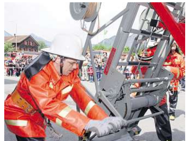
Kurbeln, kurbeln: Die als Einachsanhänger konstruierte Auszugsleiter von 1980 musste immer noch nur mit Muskelkraft auf- und abgebaut werden.
