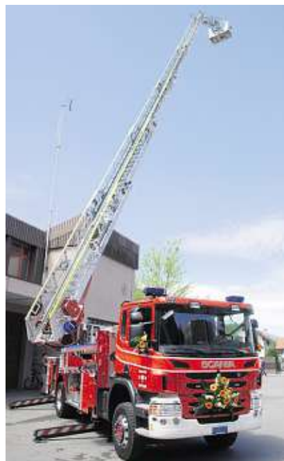
Kirchturmhoch: Mit der neuen Autodrehleiter können Personen aus einer Höhe von 32 Metern geborgen werden.
